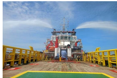
เรือสนับสนุน ภาพถ่ายที่ 2.2-34 อุปกรณ์ฉีดน้ำแรงดันสูง
