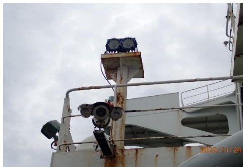
ภาพถ่ายที่ 2.2-31 Explosion Proof Instrument
