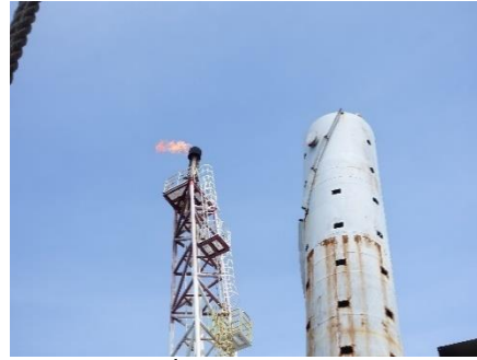
ภาพถ่ายที่ 2.2-2 ระบบเผาก๊าซ
