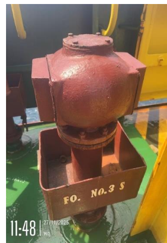
ภาพถ่ายที่ 2.2-17 ถาดรองรับด้านล่างของอุปกรณ์ และภาชนะบรรจุสารเคมี/น้ำมัน
