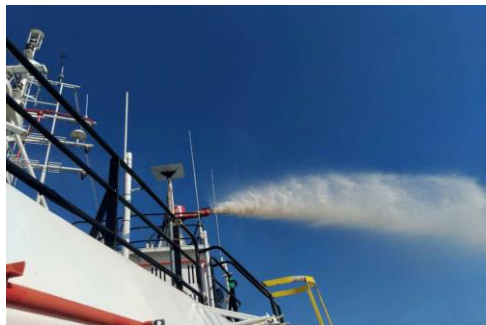
เรือสนับสนุน ภาพถ่ายที่ 2.2-34 อุปกรณ์ฉีดน้ำแรงดันสูง
