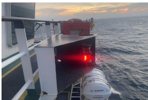
ภาพถ่ายที่ 2.2-13 สัญญาณไฟระบุตำแหน่ง
